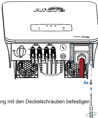
AC-Kabelabdeckung mit den Deckelschrauben befestigen
